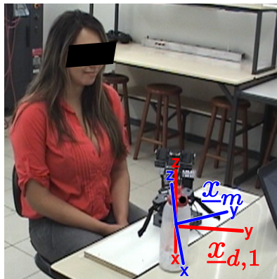
Figura 6.11: Pose final do efetador \underline{x}_m ao alcançar a garrafa. A pose \underline{x}_{d,1} corresponde à desejada para aquela etapa.
